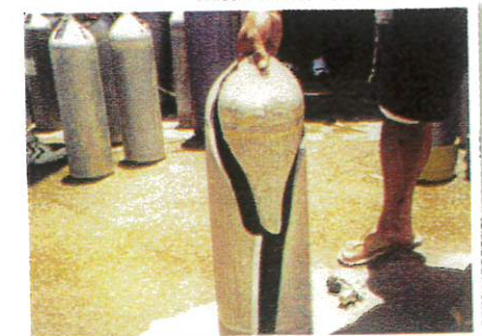
〈ねじ部クラックが原因で破綻したスクーバ容器〉
